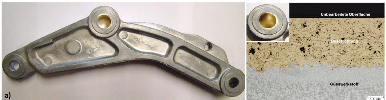
Bild 1: Demonstrator "Kleingussteil" (links) und Schliff der Verbundzone zwischen Gusswerkstoff und Beschichtung (rechts)
