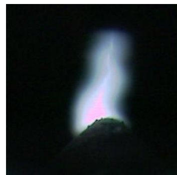
Bild 2. Entzündung des Plasmas nach einer Funkenentladung auf AISi8Cu3 mit \beta -AlFeSi, die Probe befindet sich am oberen Bildrand
